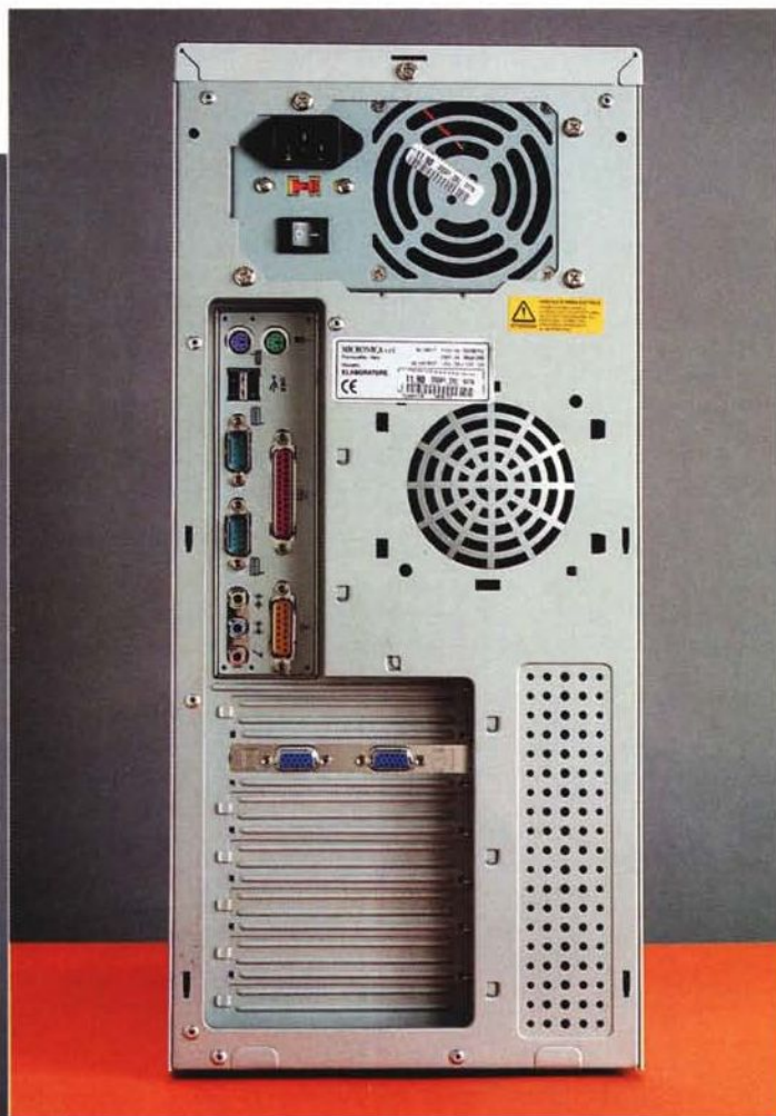
Retro del computer: tutti i connettori sono colorati come da standard PC99.
